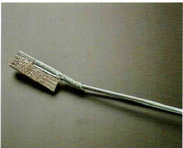
錆取り・バリ取り用を使用
